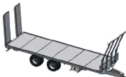
Disegno rimorchio con rampe con imperiali anteriori tipo B
