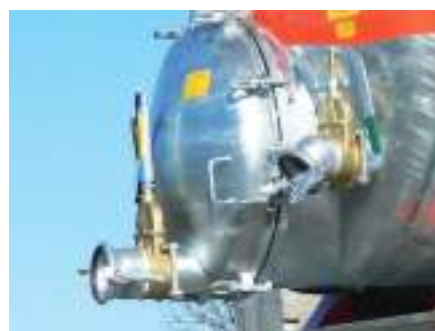
Fondo con botola Bottom with trapdoor
