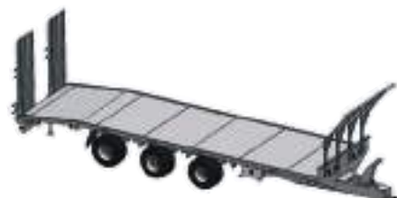
Disegno rimorchio con rampe con imperiali anteriori tipo B
