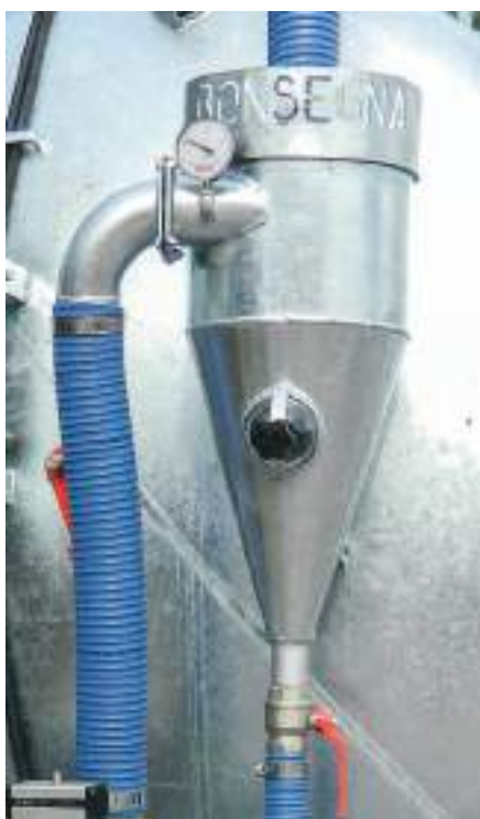
Filtro a vortice Siphon vortex
