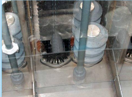
Zona lavaggio e vasca in acciaio inox, rulli trasporto più alti, doppi cuscinetti. Stainless steel washing area and stainless steel water tank, higher transport rolls, twice gall-bearing mounted.
